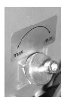
Der Luftüberschuss während der Verbrennung wird über die Luftklappe mit einem geeigneten Emissionsmessgerät angepasst.
