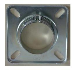
Zur Befestigung des Ölbrenners am Kessel dient der mitgelieferte Schiebeflansch, der mit vier Schrauben an der Kesselplatte befestigt wird. Der klemmbare Schiebeflansch ermöglicht es, das Flammrohr in den Feuerraum so weit einzuschieben, dass es den Erfordernissen des jeweiligen Kessels entspricht.
