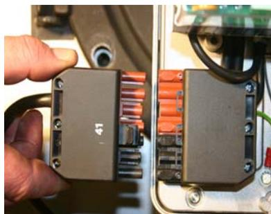
Elektroanschlussleitung vom Heizkessel auf den Euro-Stecker am C1P-Brenner aufstecken.
