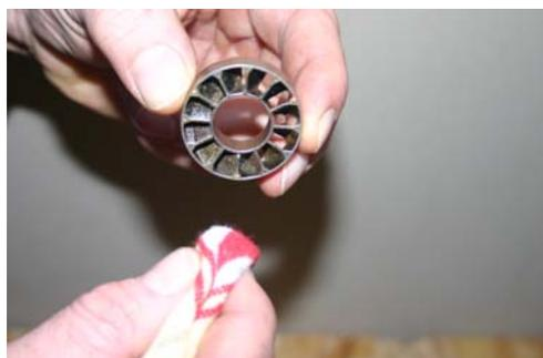
Turbulator mit Tuch reinigen.
