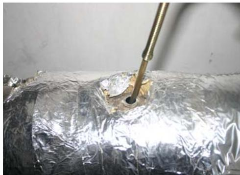
**Bei Brennerstart-** Mess-Sonde vom Emissionsmessgerät in das Messloch am Rauchrohr einführen und Abgaswerte beobachten.
