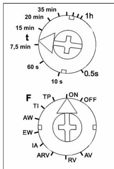
Für **Servicearbeiten** am betriebswarmen Brenner kann der Funktionswahlschalter auf Position "ON" gestellt werden. Die Startverzögerung ist damit inaktiv.
