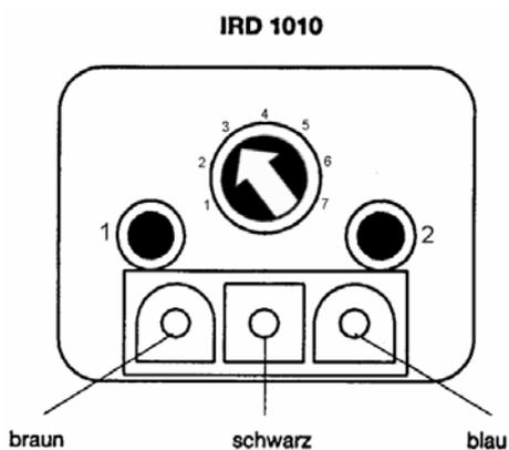
Der Infrarot-Flackerdetektor ermöglicht die Erkennung von Blauflammen. Die Grundeinstellung ist Position "3"
