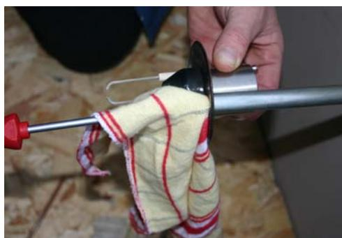
Lufthülse mit Messingdrahtbürste von Rückständen befreien.
